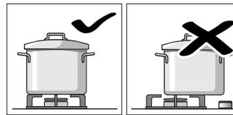
Umieszczać naczynie na palniku w położeniu dokładnie centrycznym. W przeciwnym razie może się ono wyrzucić.
