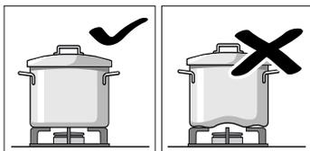
Nie należy używać odkształconych naczyń, które stoją w sposób niestabilny na płycie kuchenki i mogą się przewrócić.
