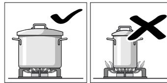
Mindig az adott égőnek megfelelő méretű edényt használjon. Ne használjon a nagy égőkön kis edényeket. A láng ne érje el az edény oldalát.
