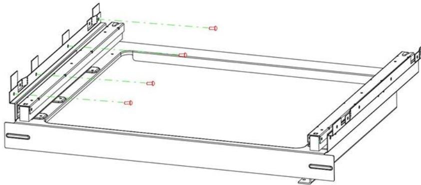
Шаг 1: при боковом методе монтажа (когда кофемашина устанавливается над ящиком для подогрева или другой техникой) установите направляющий соединительный кронштейн и закрепите его винтами.
